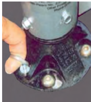
Retrait de la goupille pour le démontage.
