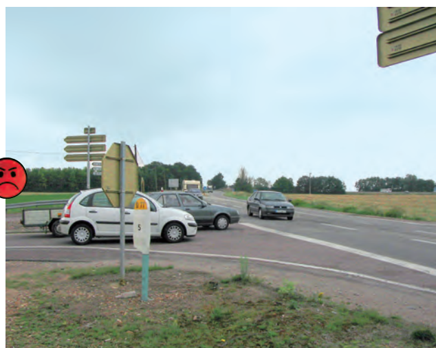
Stockés à deux de front, les usagers se masquent mutuellement la visibilité dans l'intersection.
