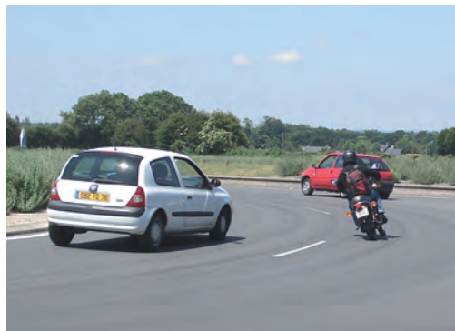
Les effets de la force centrifuge sont compensés par l'inclinaison du deux-roues motorisé. - Source : CETE Normandie Centre
