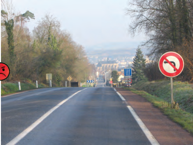
Un virage à droite qui n'est pas lisible.
