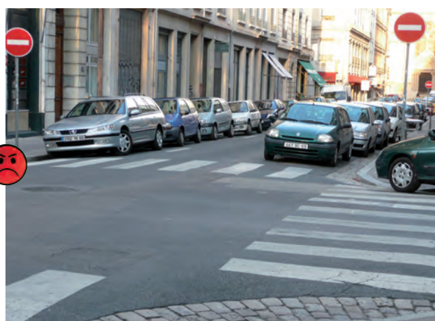
Problème de visibilité dû au stationnement, défavorable notamment à la sécurité de la traversée du piéton.
